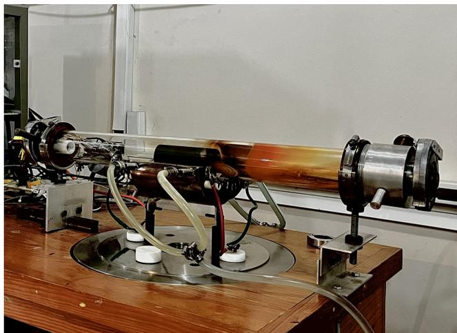
Figura 11: Imagen del MOCVD utilizado en este trabajo de tesis.
