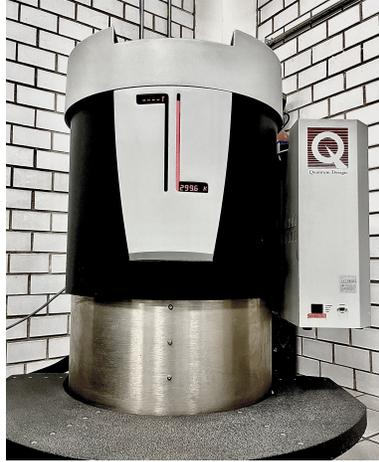
Figura 21: Equipo *PPMS-Dynacool Quantum Design* utilizado para la caracterización eléctrica de las películas obtenidas.
