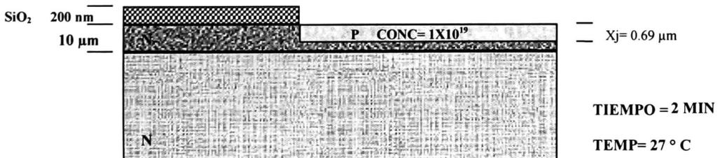
**SE CRECE UN OXIDO PARA FORMAR EL COLECTOR.**
