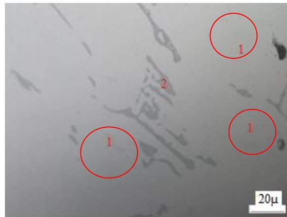
Figura 7. Micrografía a 50 X de aleación Al-Zn-Mg-(Mg) con tratamiento de retrogresión a 170 °C y 30 min.
