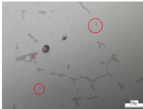
Figura 13. Fotomicrografía a 50 X de aleación con tratamiento de retroresión a 170 °C y 150 min.
