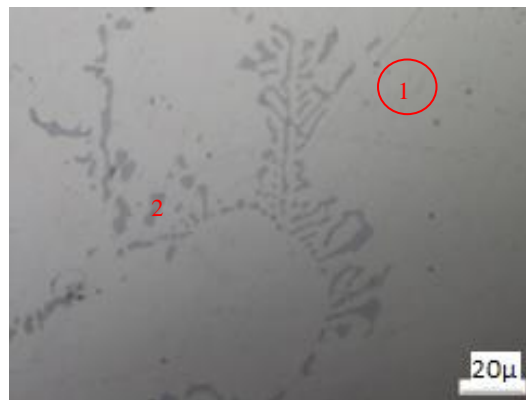
Figura 42. Fotomicrografía a 50 X de la muestra con tratamiento de retrogresión a 230 °C y 60 min.
