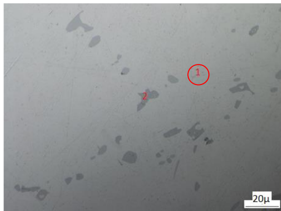
Figura 38. Fotomicrografía a 50 X de la muestra con tratamiento de retrogresión a 215 °C y 120 min.
