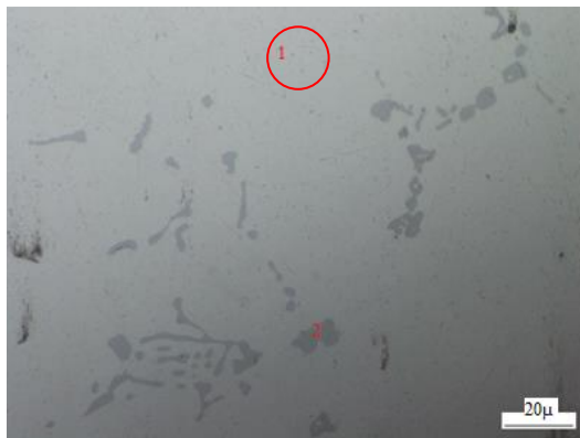
Figura 32. Fotomicrografía a 50 X de aleación con tratamiento de retrogresión a 200 °C y 120 min.
