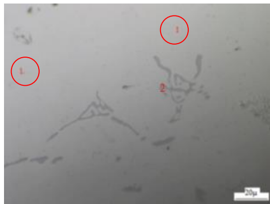
Figura 12. Fotomicrografía a 50 X de aleación con tratamiento de retroresión a 170 °C y 120 min.
