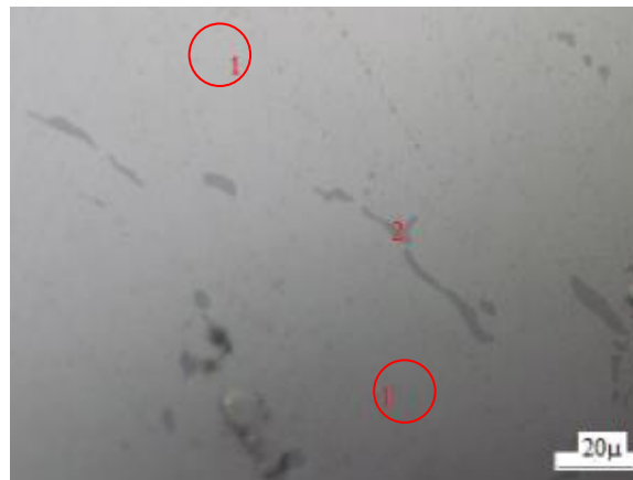
Figura 19. Fotomicrografía a 50 X de aleación con tratamiento de retroresión a 185 °C y 30 min.
