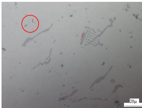
Figura 31. Fotomicrografía a 50 X de muestra con tratamiento de retrogresión a 200 °C y 90 min.
