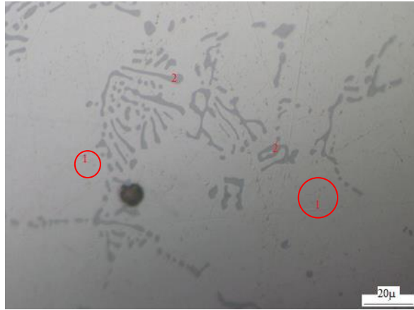
Figura 20. Fotomicrografía a 50 X de aleación con tratamiento de retroresión a 185 °C y 60 min.
