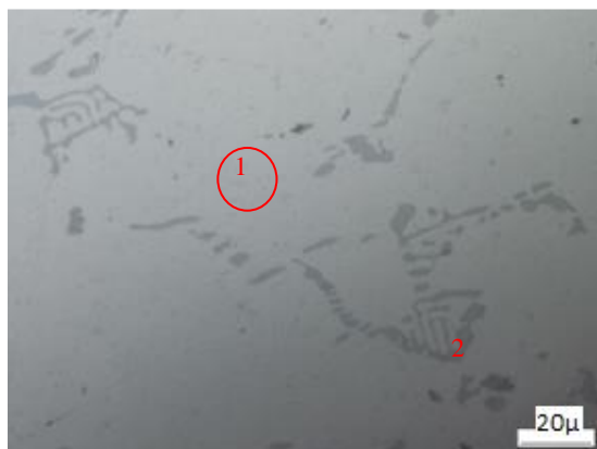
Figura 40. Fotomicrografía a 50 X de la aleación con tratamiento de retrogresión a 230 °C y 30 min.
