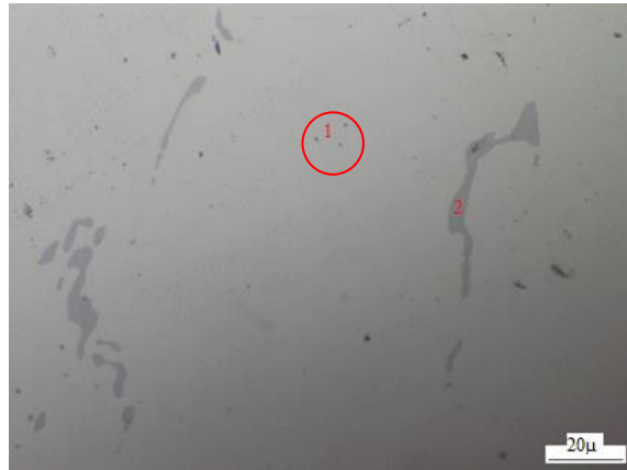
Figura 33. Fotomicrografía a 50 X de aleación con tratamiento de retrogresión a 200 °C y 150 min.
