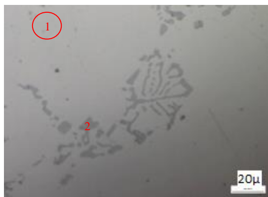
Figura 43. Fotomicrografía a 50 X de la muestra con tratamiento de retrogresión a 230 °C y 90 min.
