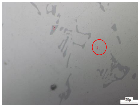
Figura 21. Fotomicrografía a 50 X de aleación con tratamiento de retroresión a 185 °C y 90 min.
