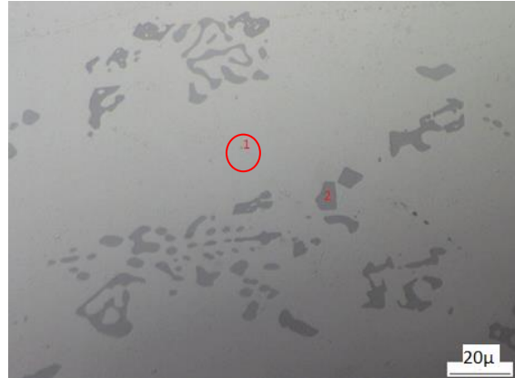
Figura 37. Fotomicrografía a 50 X de la muestra con tratamiento de retrogresión a 215 °C y 90 min.
