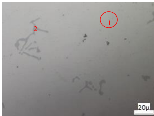
Figura 39. Fotomicrografía a 50 X de la muestra con tratamiento de retrogresión a 215 °C y 150 min.
