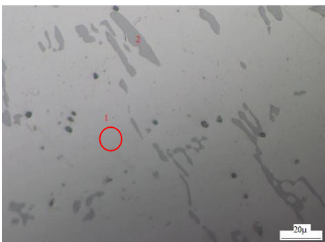
Figura 23. Fotomicrografía a 50 X de aleación con tratamiento de retroresión a 185 °C y 150 min.
