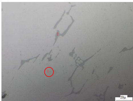
Figura 22. Fotomicrografía a 50 X de aleación con tratamiento de retroresión a 185 °C y 120 min.
