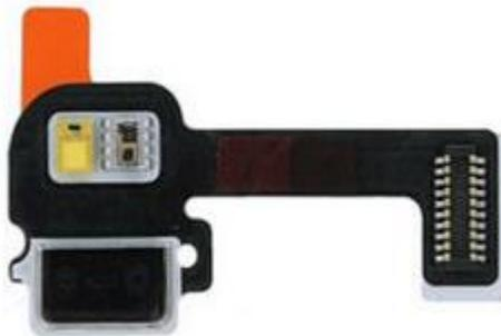
Fig. 29. Módulo de linterna Huawei utilizado como fuente de luz para el OE
