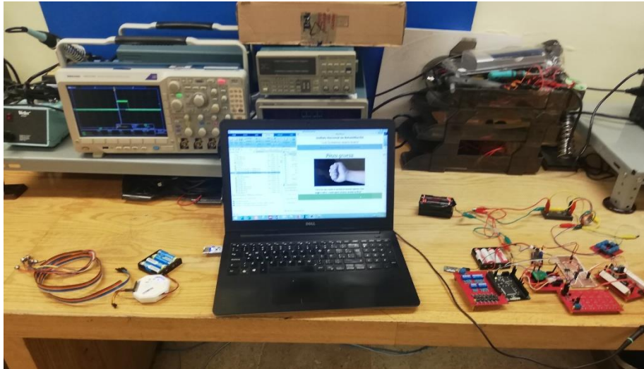
Fig. 4.24 Integración del sistema de registro OpenBCI con el Sistema de Estimulación Prototipo FES-INR v1.0
