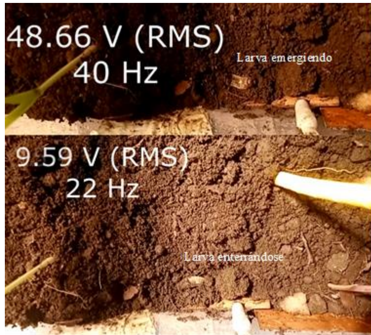
Fig. 44 Larva SM siendo aturdida eléctricamente a 1 cm del electrodo, emergiendo a 48.5 VRMS (16 mA) y volviendo a enterrarse a 9.59 VRMS (5.77 mA)
