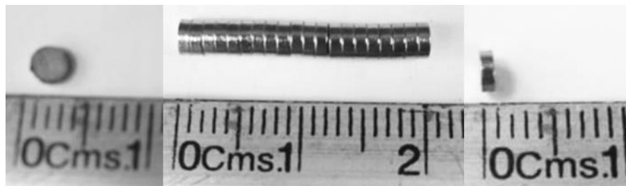
Fig. 13 Dimensiones de los imanes de neodimio N35 utilizados como marcadores en el seguimiento de larvas
