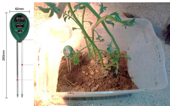
Fig. 34 Higrómetro de tierra “Soil tester” en funcionamiento para el control de humedad del terrario de crianza de larvas de escarabajos.
