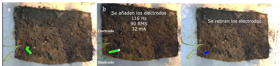
Fig. 47 Trayectoria de la larva SM al ser estimulada eléctricamente a) periodo de adaptación, sin corriente b) se aplican 90 V a 116 Hz, la larva se retira de la fuente de alimento. El punto blanco indica la última posición hasta ese conjunto de tomas c) se apaga la corriente y se retiran los electrodos, la larva regresa a la plántula.
