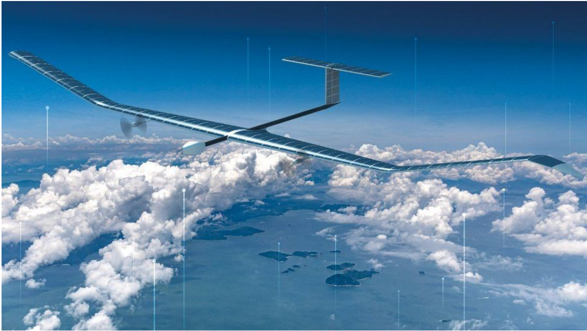
Figura 1-2: Airbus Zephyr, dron de ala fija que cuenta con paneles solares, lo cual lo hace capaz de volar por semanas.
