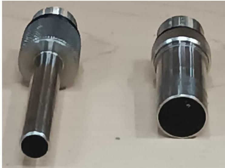
Fig. 48. Transductores de ultrasonido de 5 MHz. A la izquierda el transductor de 9.4 mm de diámetro. A la derecha el transductor de 13 mm de diámetro.
