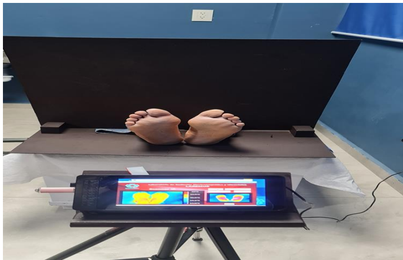
Fig. 4 Dispositivo de termografía Infrarroja Scanner IR
