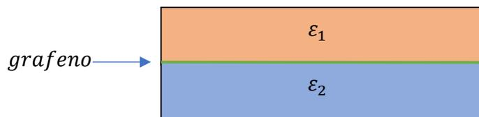
Figura 2.3 Configuración dieléctrico-grafeno-dieléctrico.  $\epsilon_1$  y  $\epsilon_2$  corresponden a las constantes dieléctricas del medio 1 y del medio 2, respectivamente.
