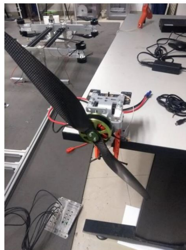
Figura 3.4: Motor montado en los bancos de pruebas 1800 y 1585.
