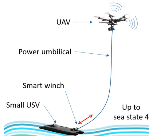
Figura 2.7: VANT atado con un cable a un vehículo marítimo.
