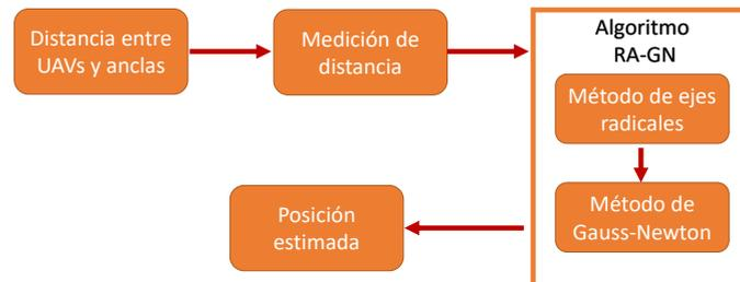
Figura 5.11: Diagrama de bloques para la estimación de posición de los UAVs.
