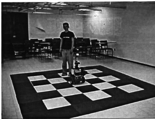
Figura 5.5: Ajedrez colocado en el piso para recuperar el factor de escala
