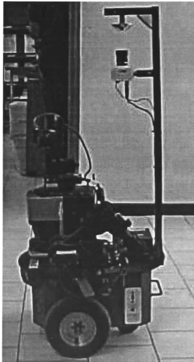
Figura 1.1: Robot Geometer, en la parte superior se encuentra la cámara y el espejo
