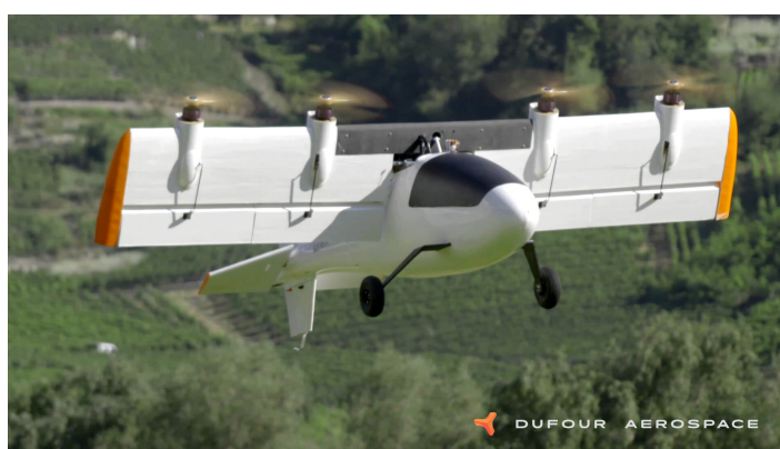
(b) aEro 1 como UAV tilt-wing.
