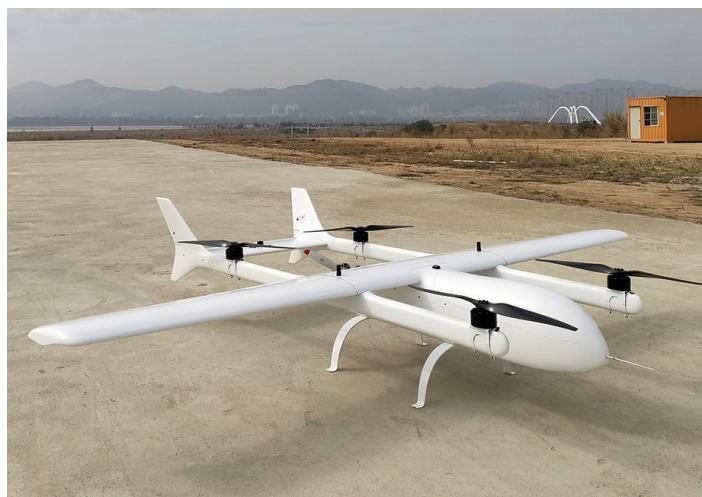
(a) Mugin 4450 como UAV tilt-rotor.
