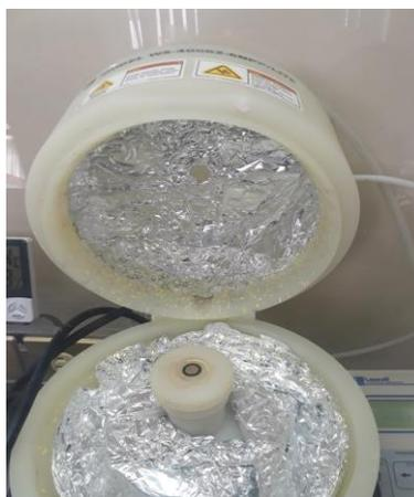
Figura 18. Sustrato de vidrio corning en la cámara de centrifugado y con la solución de la perovskita.
