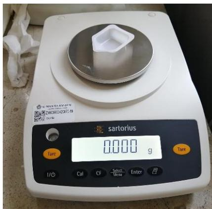
Figura 15. Pesado de los precursores  $\text{PbI}_2$ , CsI y FAI.
