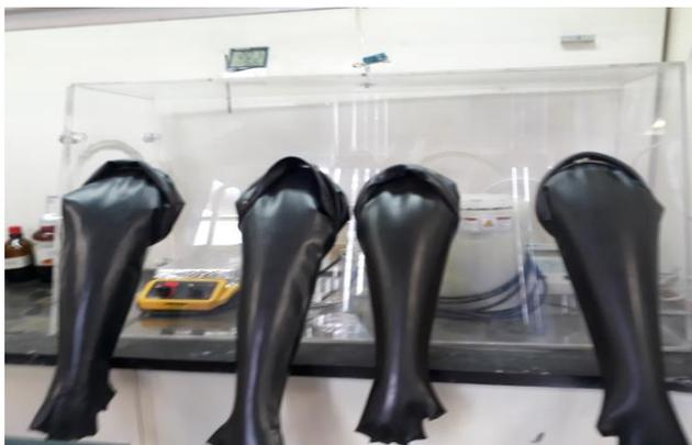
Figura 17. Cámara de guantes con atmósfera de  $N_2$  y humedad relativa menor al  $20 \%$ .
