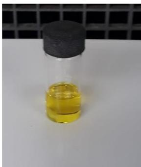
Figura 16. Disolución en DMF/DMSO durante 90 min a  $65^\circ\text{C}$ .
