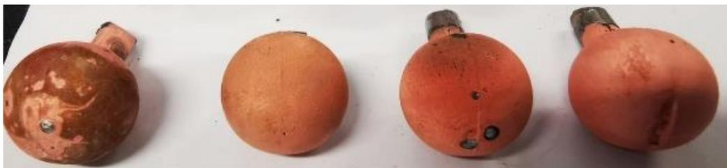
Figura 43 Depósitos obtenidos con corriente pulsada a -2.2V usando ánodo de cobre
