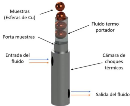
Figura 52 Cámara de choques térmicos.
