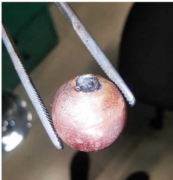
Figura 49 Esfera de Cu posterior al proceso de la extracción del núcleo de Pb-Sn
