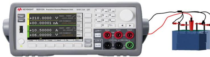
Figura 18 Montaje del sistema de electrodeposición por corriente continua.
