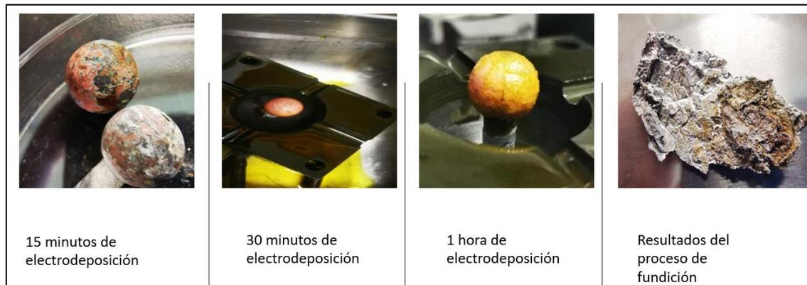
Figura 40 Esferas de cobre electrodepositadas en etalina.
