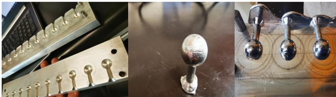
Figura 35 Molde bipartido antes y después del proceso de vaciado de las esferas de Pb-Sn.
