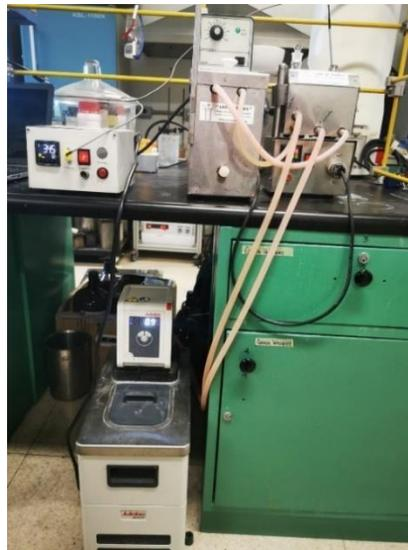
Figura 53 Sistema de ciclado térmico.
