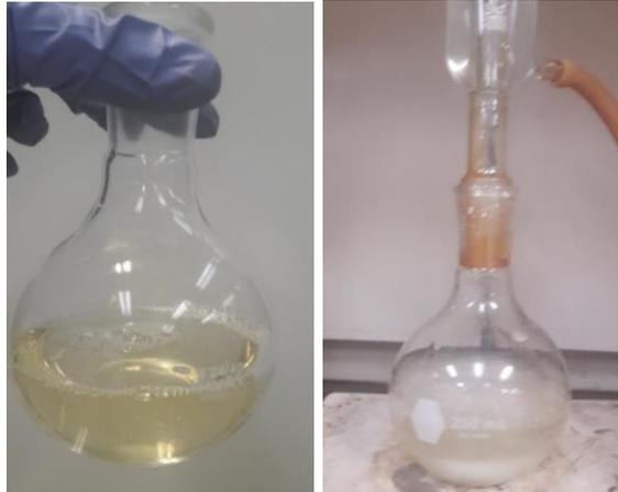
**Figura 47.** Proceso de obtención de scorodita atmosférica utilizando medio de cultivo de *T. atroviride*.
