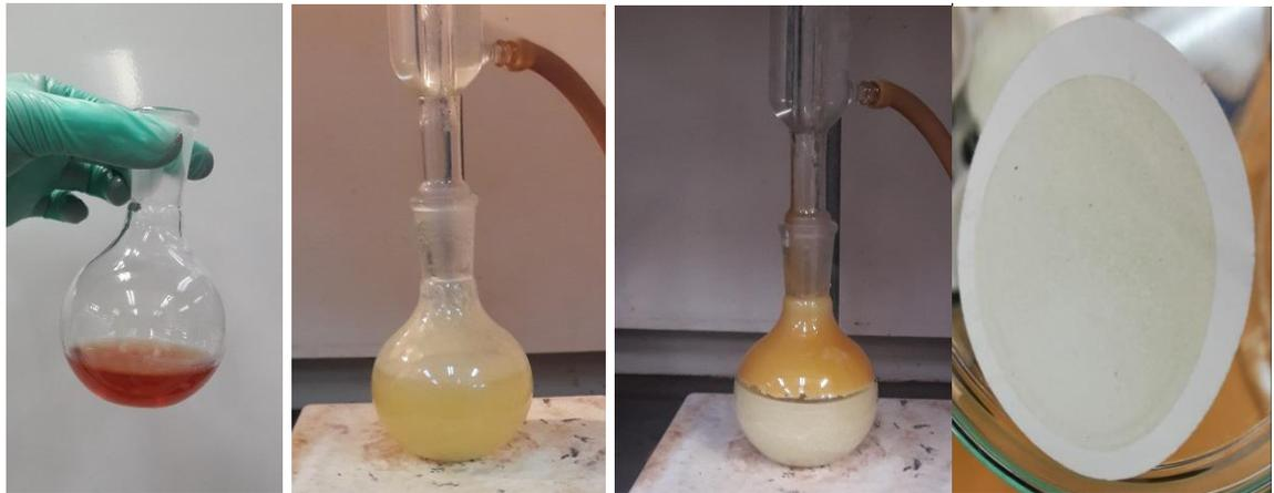
**Figura 43.** Proceso de obtención de escorodita atmosférica utilizando sulfato férrico como fuente de  $\text{Fe}^{\text{III}}$ .
