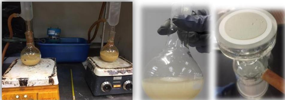
**Figura 44.** Proceso de obtención de bioscorodita utilizando las diferentes cepas.
