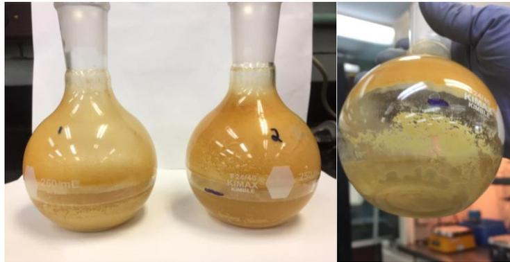
**Figura 45.** Proceso de obtención de bioscorodita utilizando el hongo *P. chrysosporium*.
