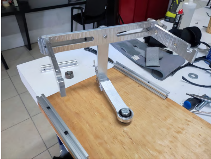
Figura 7.14: La plataforma construida para calibración del helicóptero está fabricada de aluminio 6061-T6.
