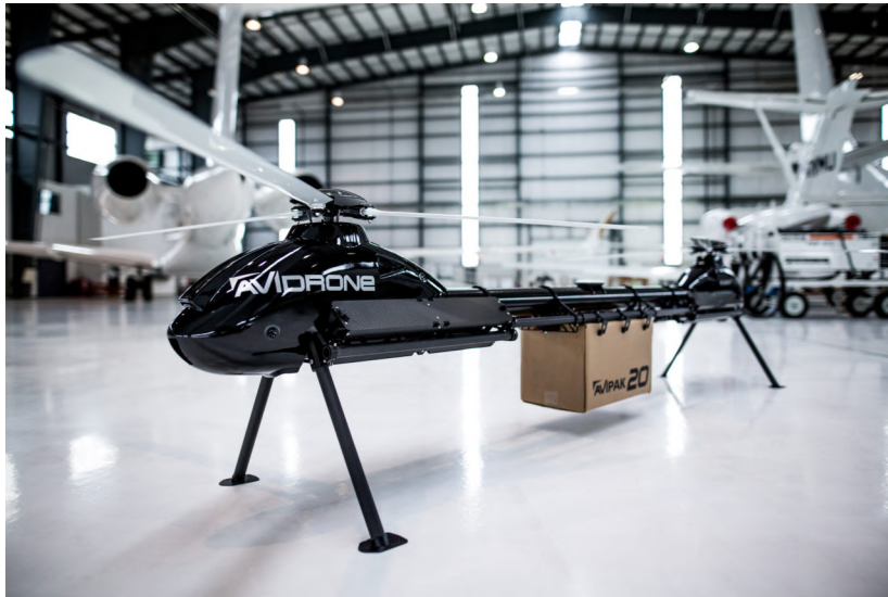
Figura 1.5: El 210TL tiene un tiempo de vuelo de 1.3 horas y alcanza velocidades de hasta 100 km/h. (Imagen tomada de Avidrone Aerospace [10]).
