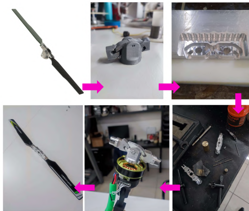
Figura 4.14: De izquierda a derecha y de arriba a abajo: Diseño en CAD. Prueba de concepto. Manufactura en CNC. Ajustes. Montaje. Ensamblado
