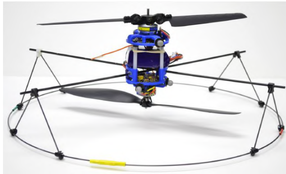
Figura 2.4: El helicóptero coaxial del doctor Paulos consta únicamente de dos actuadores y posee control cíclico sin plato cíclico convencional (imagen tomada de (imagen tomada de Rotorcraft blade pitch through torque modulation [16])).
