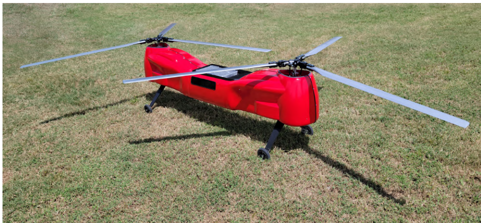
Figura 1.4: El Anzen EG-1250 posee un tiempo de vuelo de hasta 6 horas y sus rotores tienen un diámetro de 8 pies. (Imagen tomada de UAS Global Services [9]).
