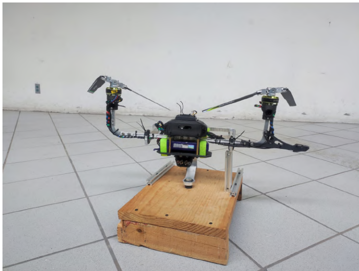
Figura 7.15: El prototipo fabricado en esta investigación montado sobre la plataforma de pruebas construida para compensar yaw .
