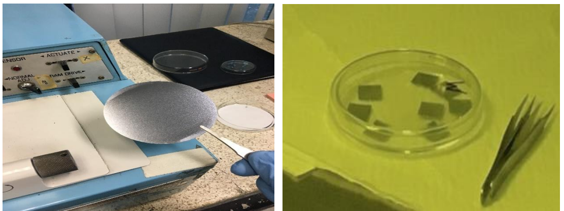
Figura. 13. Izquierda: Oblea de silicio tipo p. Derecha: Unidades cuadradas de 15 \times 15 \text{ mm} de silicio tipo p con contacto trasero de aluminio y plata.
