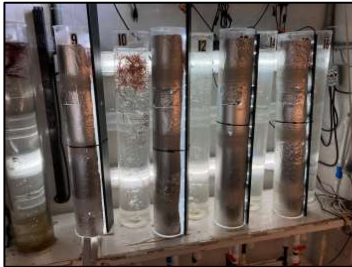
Figura 13. Montaje experimental para el sistema de biorreactores utilizado en los ensayos con diferentes condiciones de luz del capítulo II. La luz es suministrada a lo largo del cilindro transparente.
