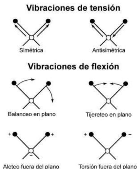
**Figura 2.20 Esquema de las vibraciones moleculares [37].**
