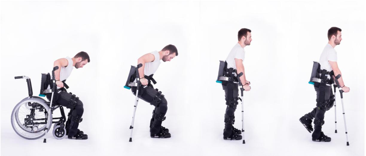
Figura 1.3: Exoesqueleto para rehabilitación
