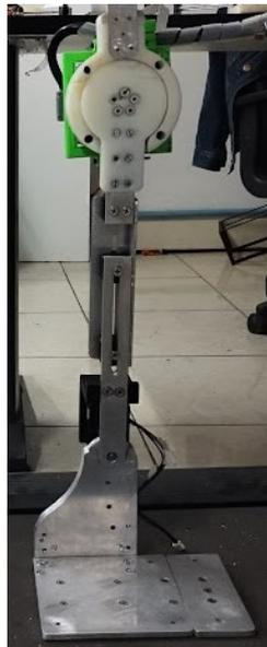
Figura 3.22: Ensamble de la pierna izquierda del exoesqueleto
