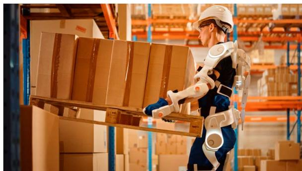
Figura 1.1: Exoesqueleto potenciador para cargas pesadas
