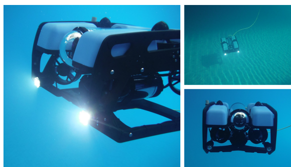
Figura 1.1: Vehículo submarino BlueROV2 de la empresa Blue Robotics 1
