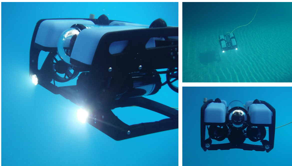
Figura 1.12: Vehículo submarino BlueROV2 disponible en el Laboratorio UMI-LAFMIA
