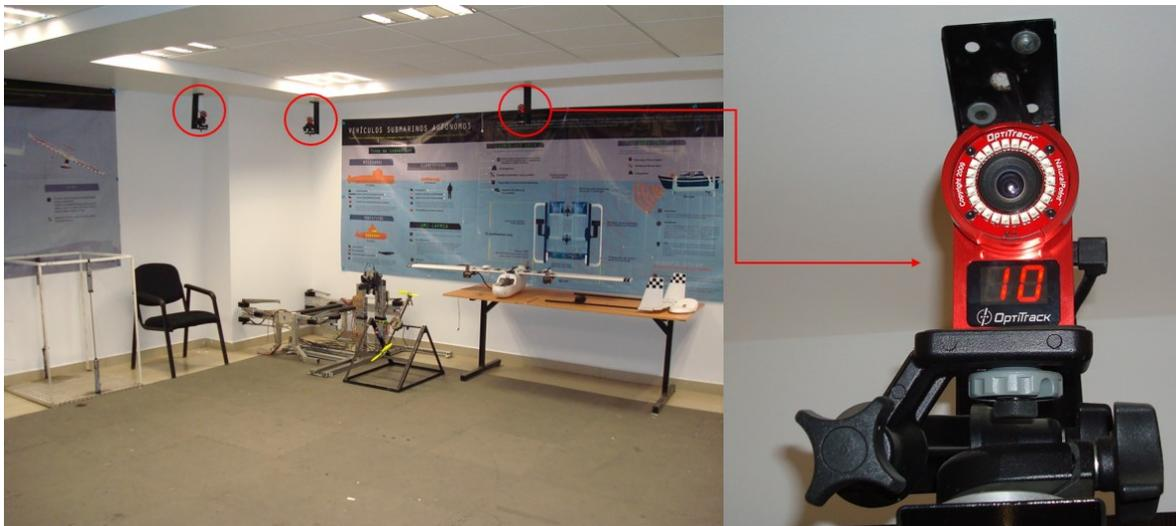
Figura 5.8: Cuarto de Cámaras y tipo de cámaras utilizado para simular el ciclo de la marcha.
