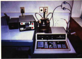
Figura 4.1. Fotografía del sistema de erosión catódica empleado
