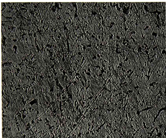
Fig. 51 Hidróxido de aluminio, secado a 100° C, 10x
