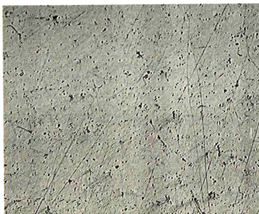
Fig. 53 Hidróxido de aluminio, sinterizado a 215° C, 10x
