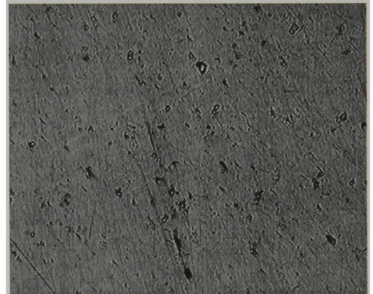
Fig. 46 Ácido bórico, sinterizado a 215° C, 10x
