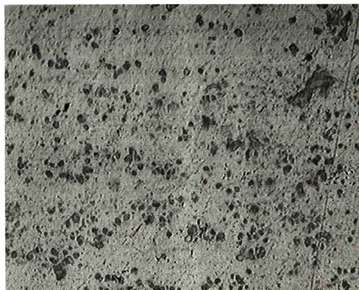
Fig. 44 Ácido bórico, secado a 100^{\circ}\text{C} , 50x
