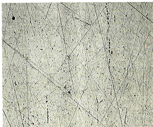
Fig. 54 Hidróxido de aluminio, sinterizado a 250° C, 10x
