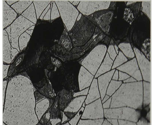
Fig.49 Ácido bórico rampa de Temperatura, 10x
