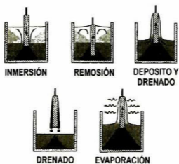
Figura 2.1 Etapas durante el proceso de inmersión empleado para la preparación de recubrimientos
