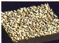
Fig. 5F.24 Imágenes de AFM para la muestra con 1.5 hrs. de depósito.
