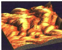
Fig. 5F.25 Imágenes de AFM para la muestra con 5 hrs. de depósito.
