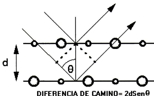
Figura 3.7. Difracción de rayos x por planos cristalinos paralelos
