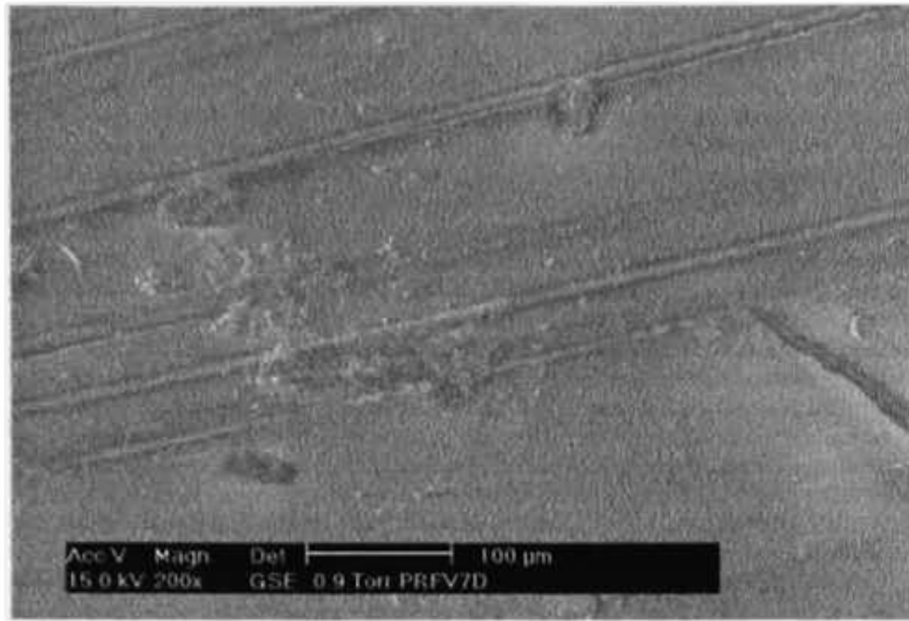
Figura (25) Superficie de PRFV a los 7 días de inmersión en la matriz de cemento.
