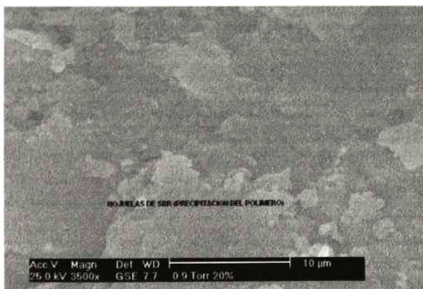
Figura (8C) Precipitación de polímero y formación de grandes hojuelas de polímero SBR.
