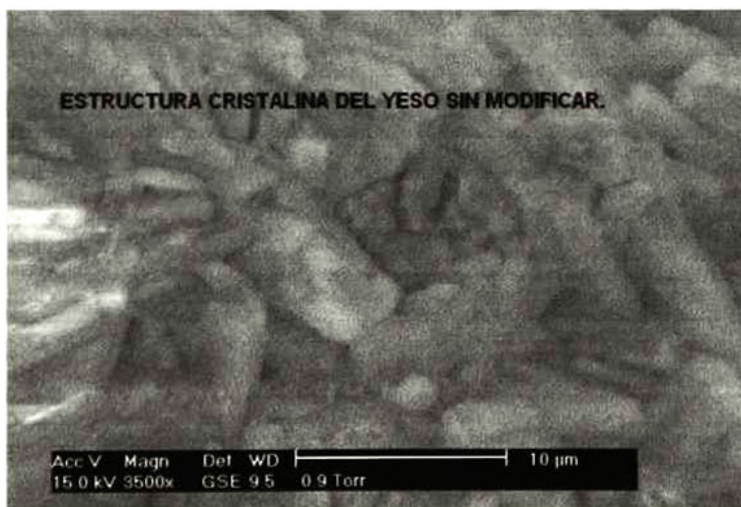
Figura (5) Estructura cristalina de la matriz de yeso sin modificar.
