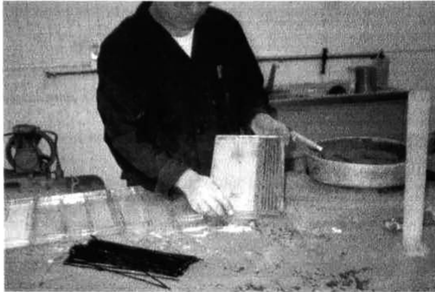
Fig. (8) Colocación de los PRFV recubiertos o sellados con Asfalto oxidado.
