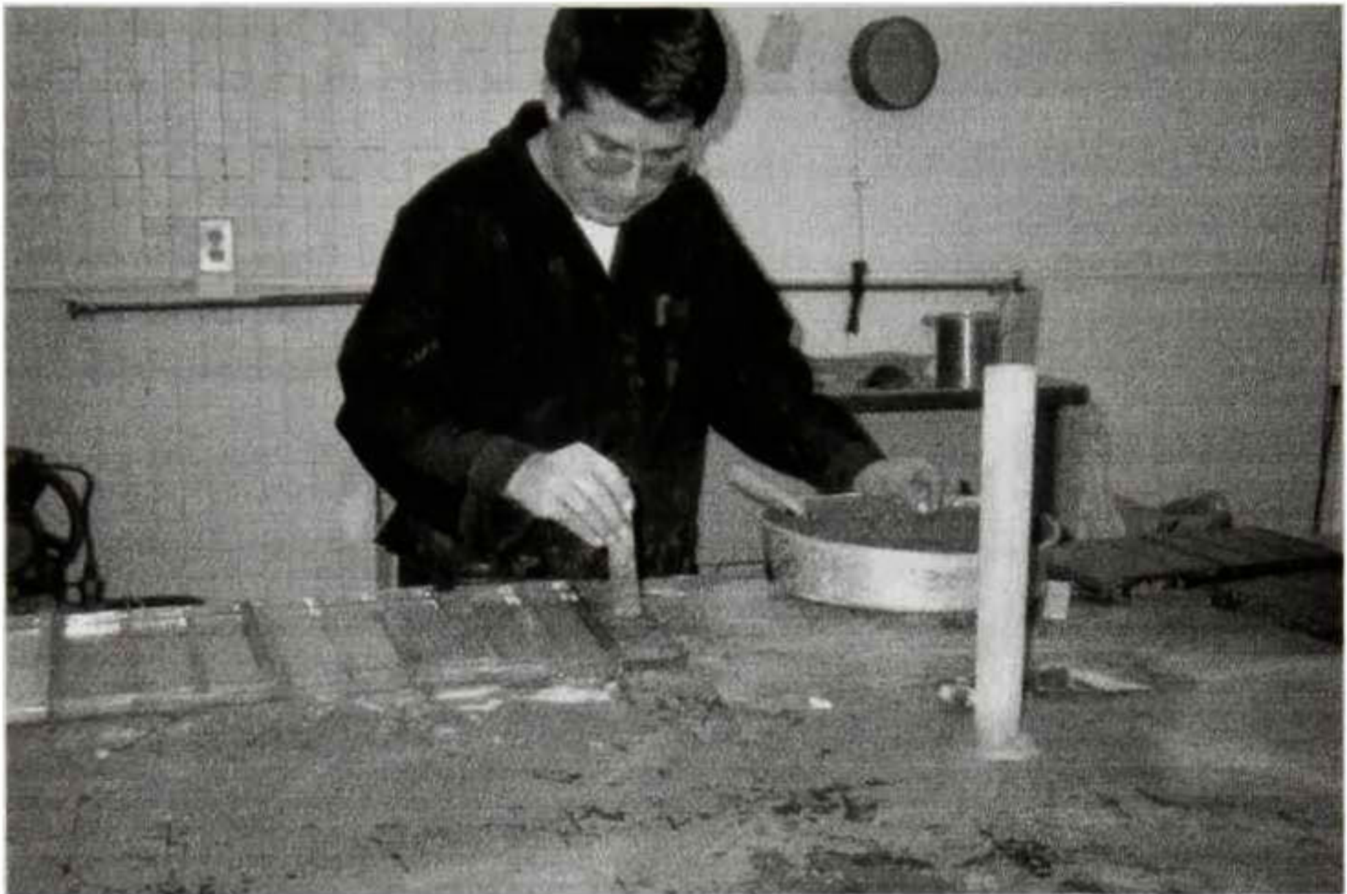
Fig. (7) Colocación de la primera capa de mortero fresco dentro de un molde.
