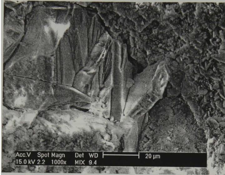
**Fig 5.3.6.4 Imagen SEM de zeolita Natural (clinoptilolita) pura**
