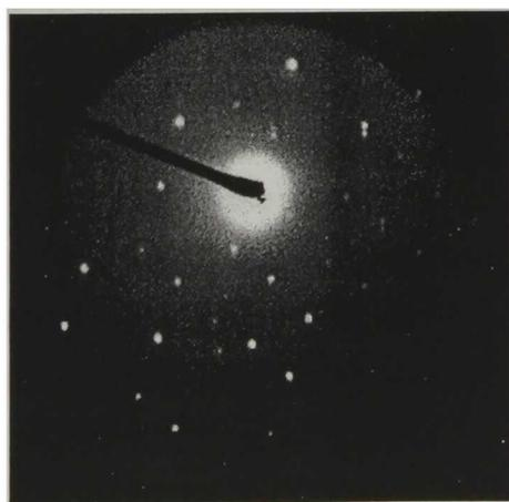
*Fig. 5.3.5.9 Patrón de Laue producido por nanopartículas de PbS en zeolita FYNH<sub>4</sub>*
