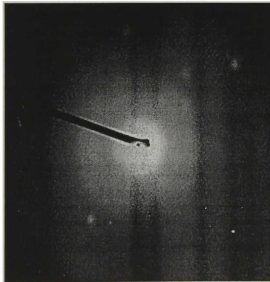
***Fig 5.3.4.9 patrones de difracción de Laue producido por nanopartículas de PbS en zeolita F9NaX***
