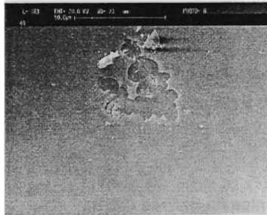
Figura 42. Imagen de MEB para el recubrimiento de sílice obtenido por inmersión sinterizado a 100° C después de aplicar una disolución-erosión.
