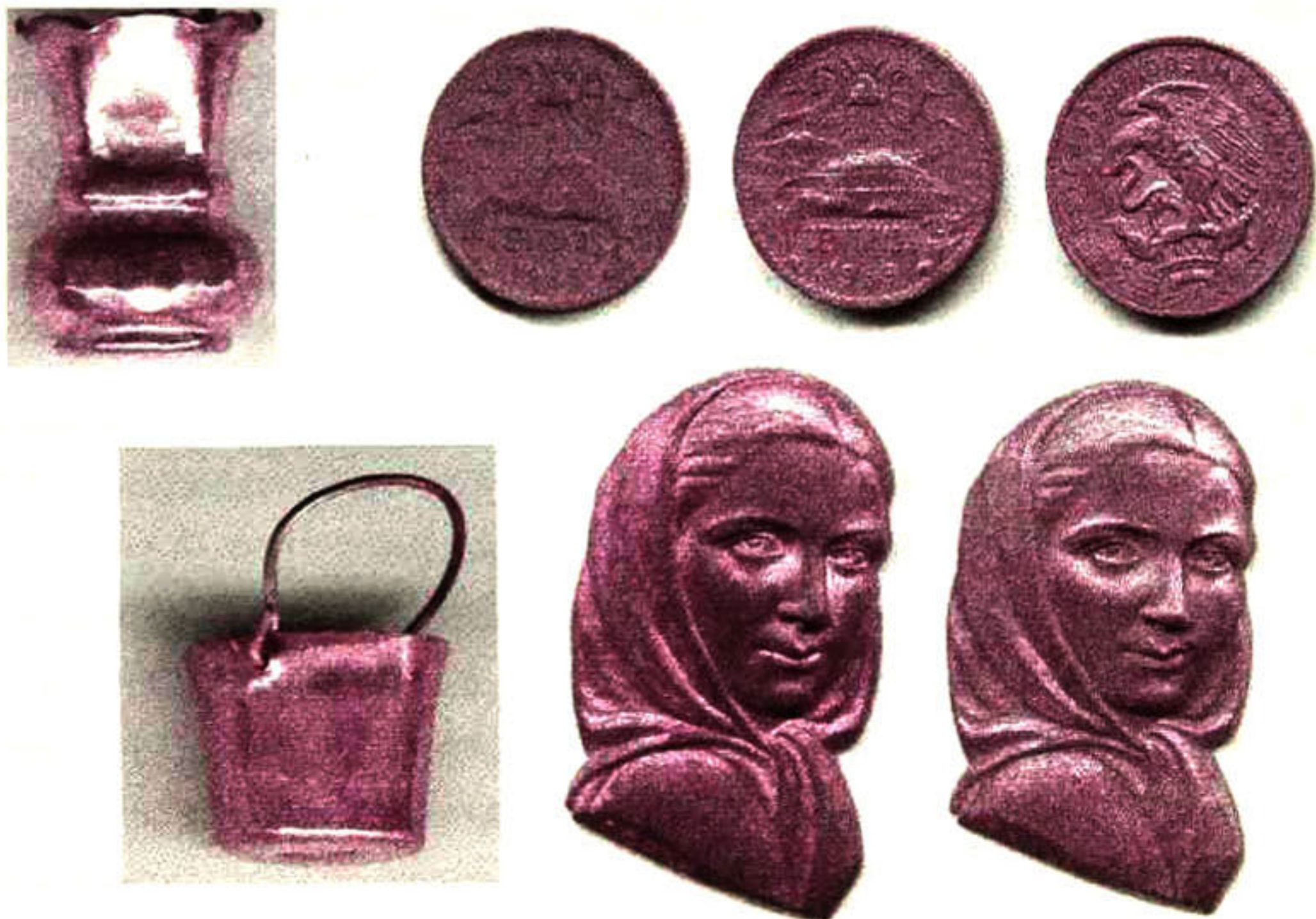
Figura 122. Deposito de sílice sobre sustratos de cobre con formas diversas.
