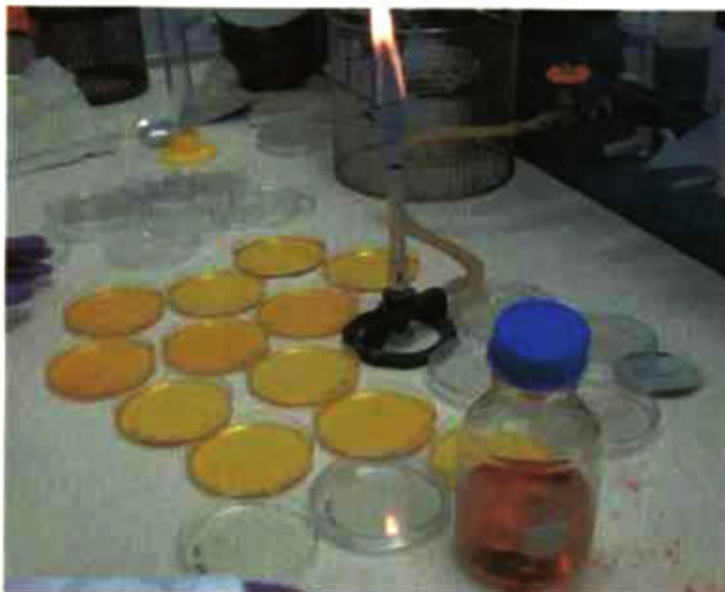
Fig. 5.1.2.5 Diluciones colocadas en cajas petri estériles, a las que se les agregó Agar soya Trypticaseina fundido y a una temperatura de 44°C
