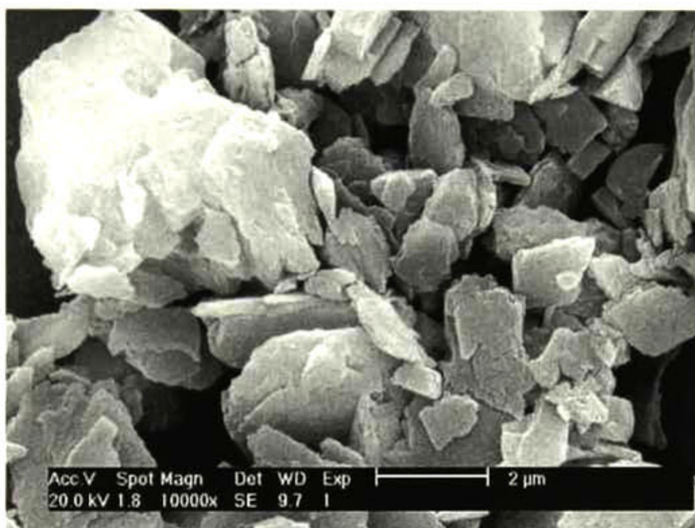
Fig.6.3.14 Imagen obtenida en el microscopio electrónico de barrido de cristales de zeolita natural Clinoptilolita alojando iones de Cu y Ag.
