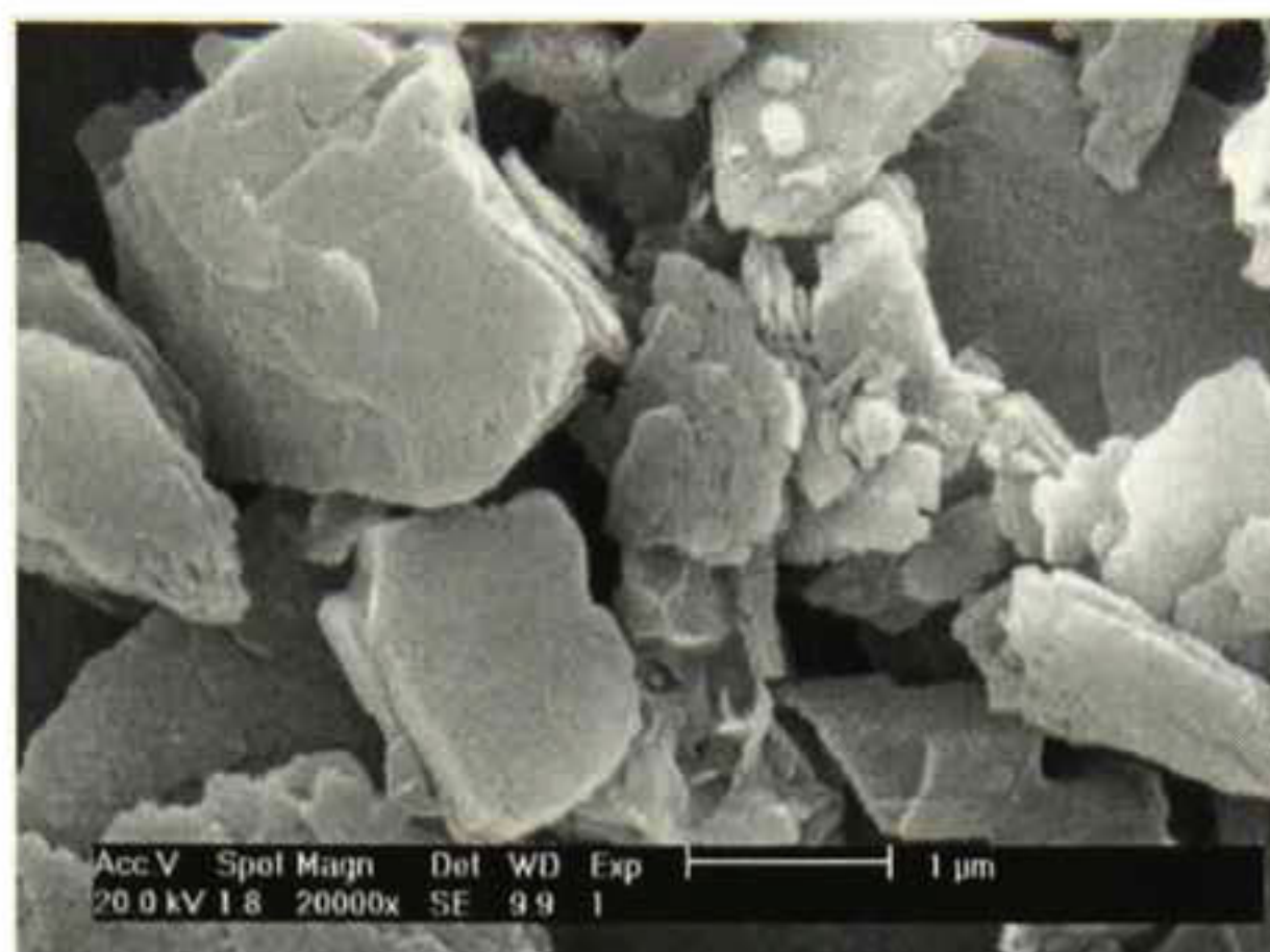
Fig.6.3.15 Imagen obtenida en el microscopio electrónico de barrido de cristales de zeolita natural Clinoptilolita alojando iones de Zn y Ag.
