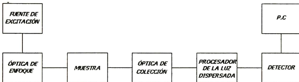
Figura 2.10 Diagrama de bloques del arreglo Raman.
