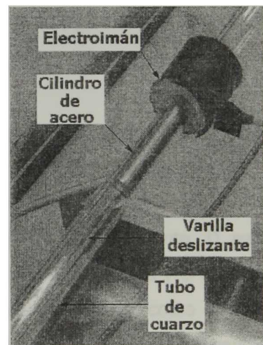
Figura 3.3 Vista en detalle (Partes) de la varilla deslizante
