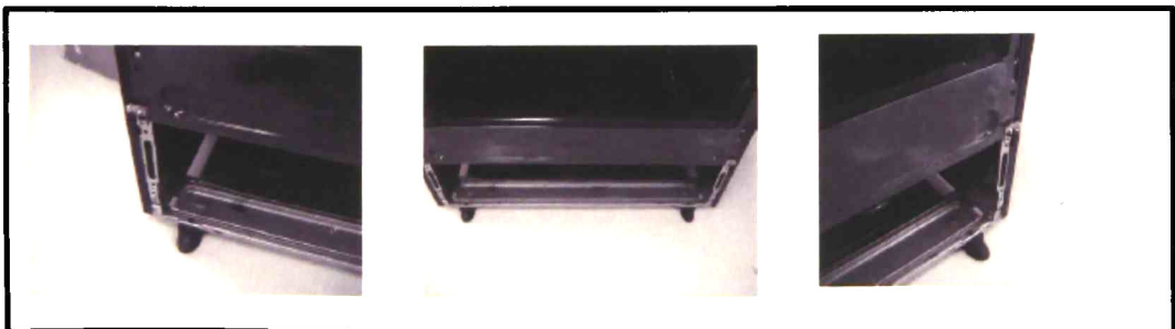
Figura 3.35. Evidencia de la no presencia de componentes deformados permanentemente.
