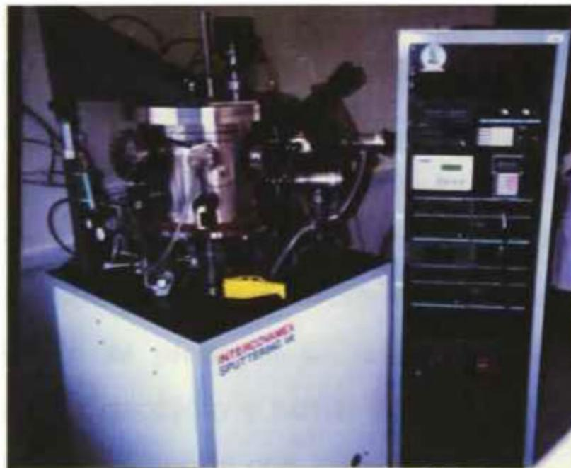
**Figura 4.1** Sistema de erosión catódica utilizado en el depósito de las películas CdTe:Sb utilizadas en la fabricación de celdas solares.
