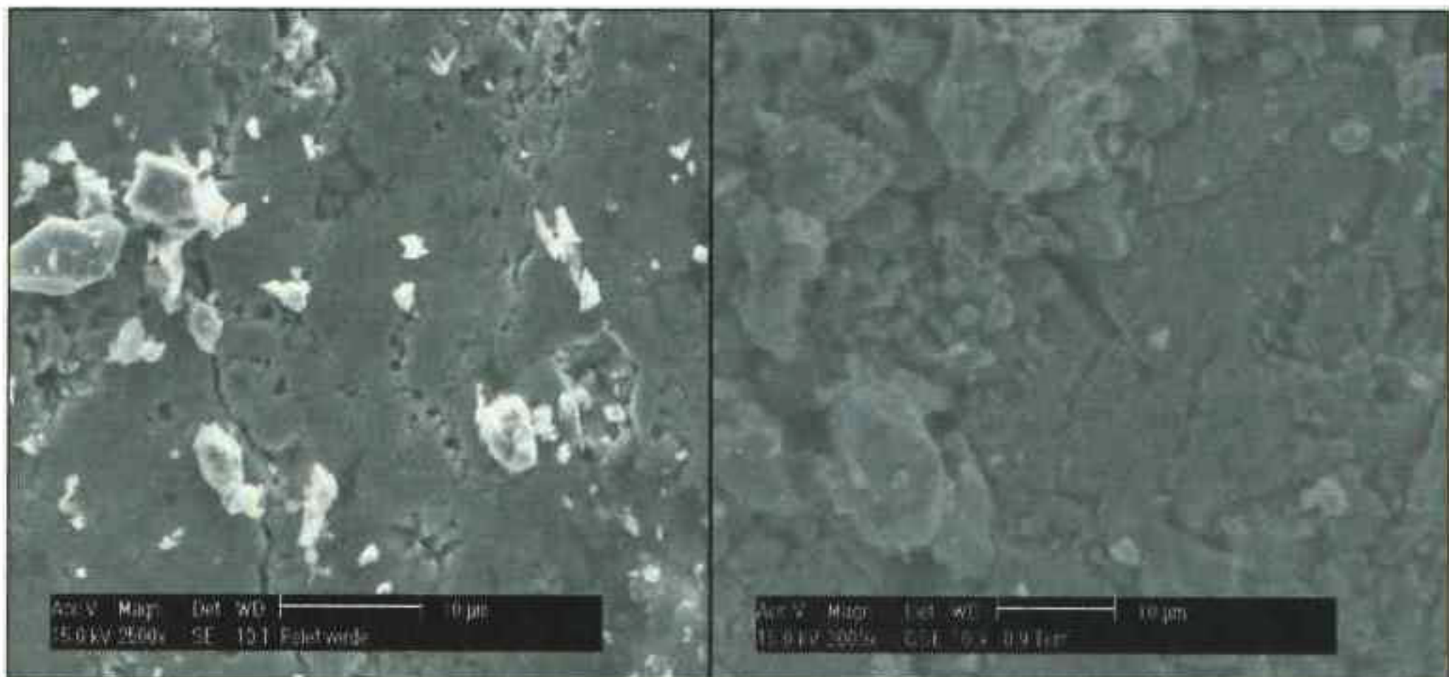
Figura 5.17 Pastillas de mineral de hierro en pelet verde (izquierda) y tratada a 450 °C (derecha).
