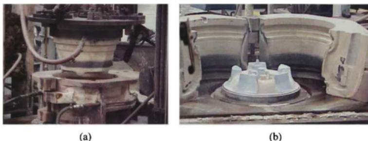
Fig. 2.3 Ensamble de molde mostrando: a) El calabazo entrando en las hojas y b) la cara con las hojas abiertas.
