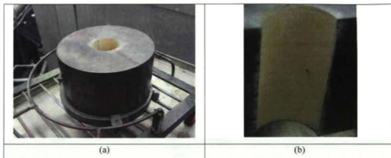
Fig. 3.14 Molde recubierto con pintura café a) Preparado para vaciar, b) Detalle del barreno pasado.
