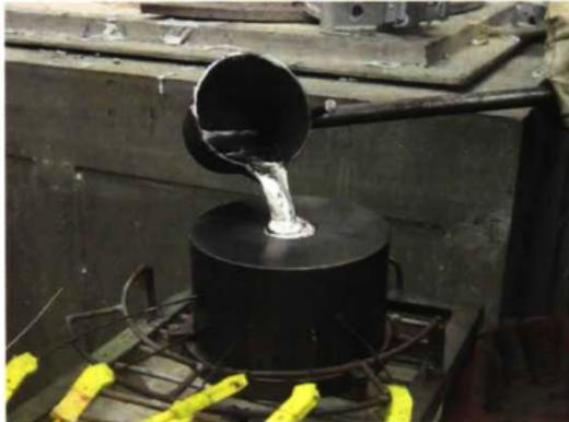
Fig. 3.18 Vaciado de la aleación en el molde experimental.
