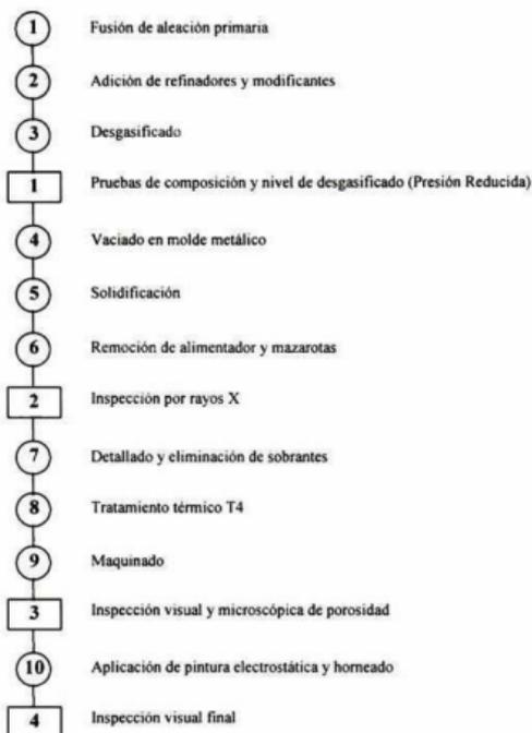
Fig. 2.2. Diagrama de proceso de American Racing.
