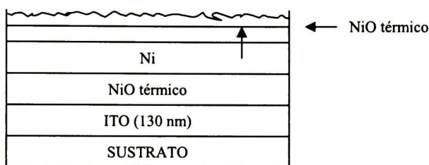
Figura 6.31. Esquema de representación para el proceso de oxidación térmica por etapas.
