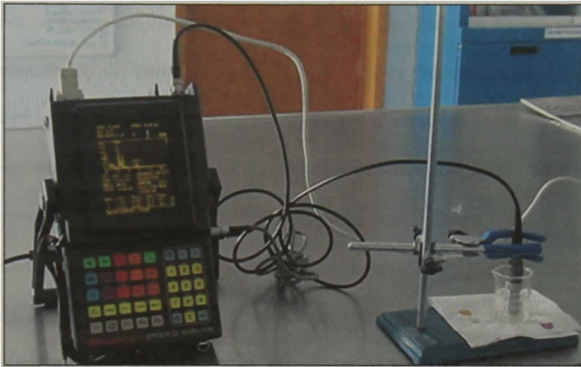
Figura 19. Equipo de ultrasonidos marca Panametrics.
