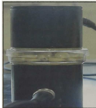
Figura 23. Celda contenedora de los granos de maíz para el método de ultrasonido de onda continua
