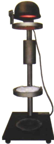
Figura 17 Equipo para el ensayo de goteo
