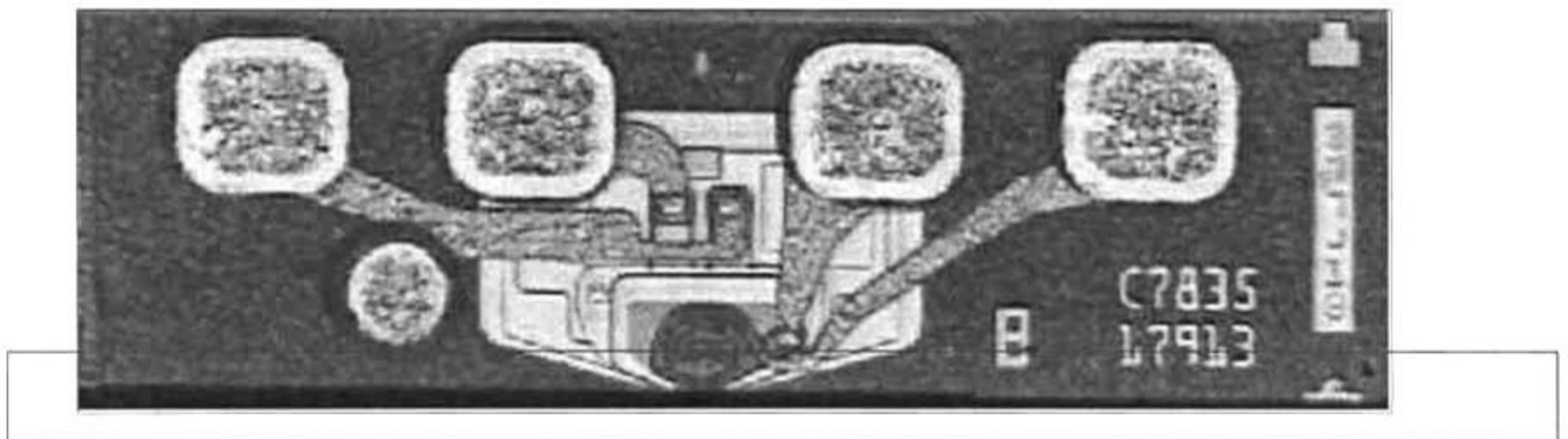
Figura 5.6 Pared de una cabeza magnética sin contaminación mostrada en el cuadro, imagen obtenida en un microscopio con una magnificación de 10x.
