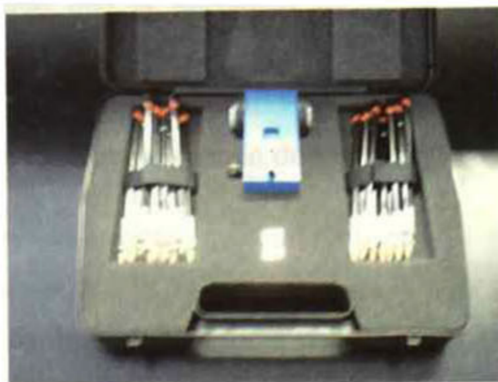
FIGURA 2.27. Durómetro de Lápices para medir la dureza según la Norma ASTM D3363.
