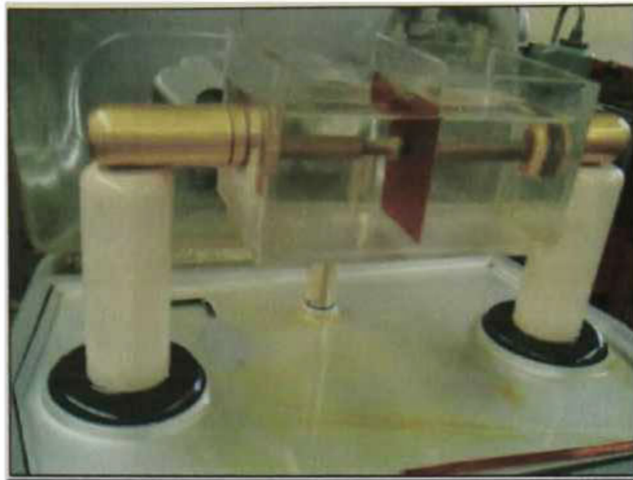
FIGURA 3.10 Colocación de las placas en medio de los dos electrodos para medir el rompimiento eléctrico
