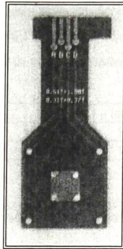
Figura 6.4.6 Montaje de la película para su análisis por efecto Hall; los contactos utilizados fueron hechos de indio.
