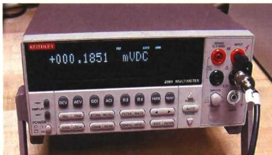
Figura 4.32. Multímetro marca Keithley 2001
