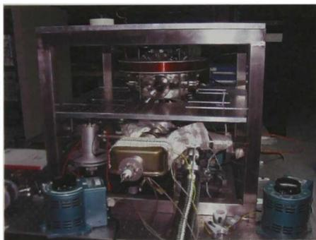
Figura 4.24. Sistema de vacío, conjunto de cámaras esférico-cúbicas y soportes
