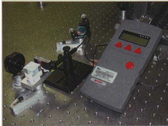
Figura 4.16. Medidor de potencia óptica con intervalos de medición de 30 mw hasta 30 nW.
