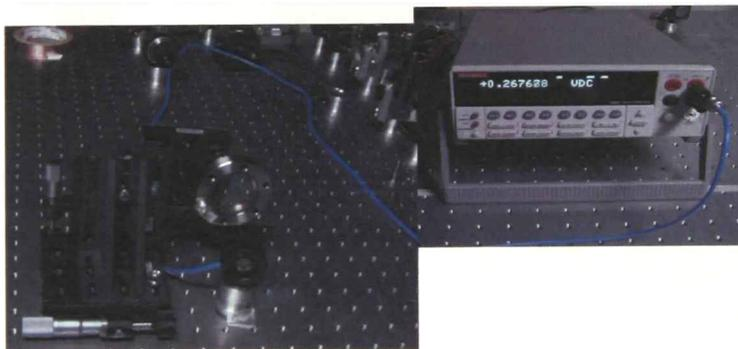
Figura 4.20. Arreglo óptico utilizado para medir la homogeneidad de las 12 ventanas de sílice fundida
