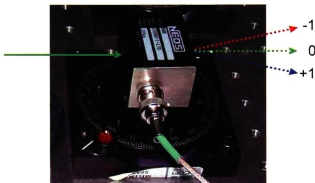
Figura 4.8. Modulador acusto-óptico. La flecha de color verde representa el haz de luz incidente (verde continuo), a la salida tenemos tres de los armónicos (flechas a trazos): -1 (luz corrida al rojo), 0 (luz incidente) y +1 (luz corrida al azul)
