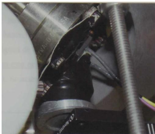
Figura 4.34. Ventana de la MOT cubierta con una máscara para permitir que solo la luz emitida por la nube de átomos fríos sea registrada por el fotodetector
