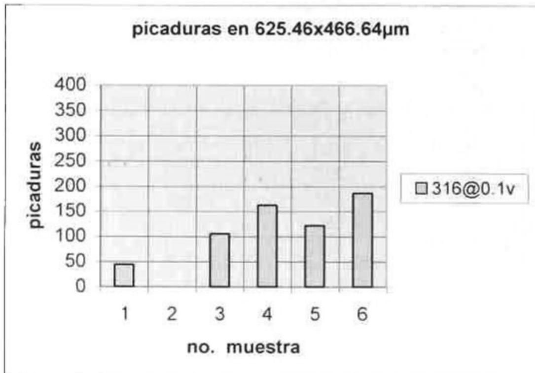
Figura 3.33. Resultados de la prueba para la serie del acero 316 a 0.1 V<sup>o</sup>
