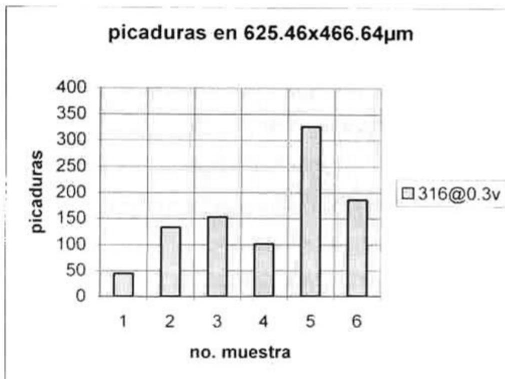
Figura 3.35. Resultados de la prueba para la serie del acero 316 a 0.3v<sup>a</sup>
