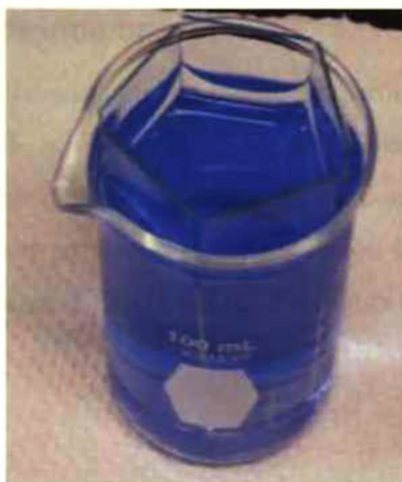
Figura 4.2. Baño de reacción de la formulación p23, la coloración azul de la solución se debe a la formación del ion complejo intermediario.
