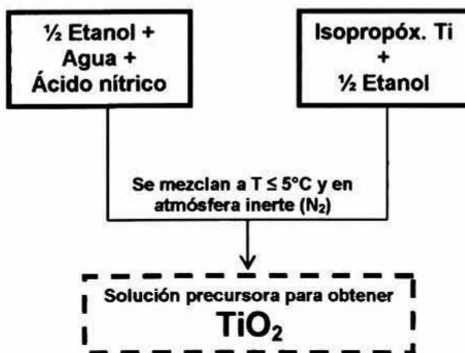
**Figura 4.3.** Diagrama que resume el procedimiento usado en la preparación de la solución precursora para la obtención de  $\text{TiO}_2$ .
