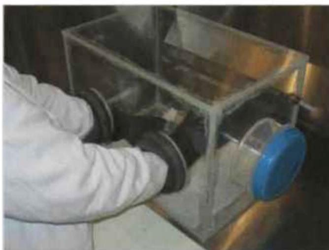
**Figura 4.2.** Caja de guantes utilizada en la preparación de soluciones precursoras de  $\text{TiO}_2$ , utilizando atmósfera de nitrógeno.
