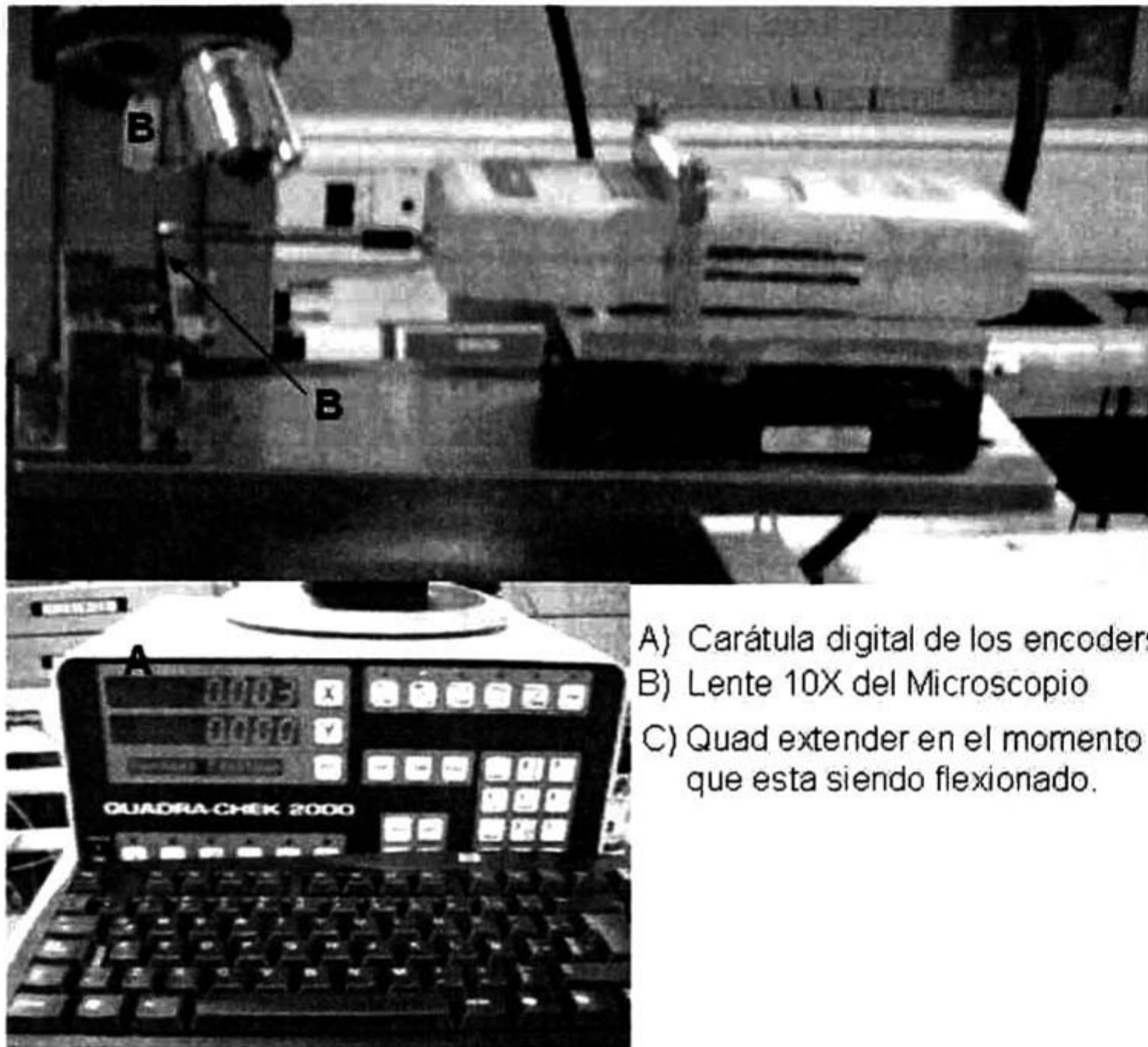
Figura 40 Diseño del mecanismo para adaptar el dinamómetro y el material de prueba al sistema de medición y microscopio para medir la fuerza adhesión en el quad- extender.
