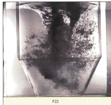
Figura 4.3 Efecto del tipo de rotor y del uso de mampara sobre el vórtice y la distribución de las burbujas. Condiciones: N= 800\text{rpm} , Q= 3\text{l/min} y h= 75\text{mm} .
