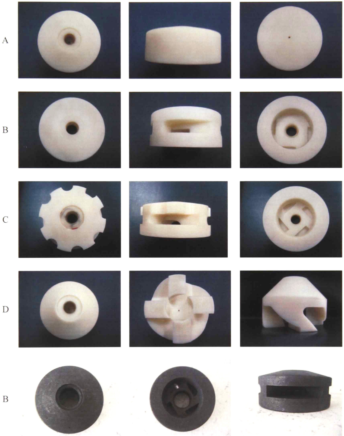
Figura 3.9 Rotores utilizados: A rotor sólido y liso, B rotor hueco con ventanas laterales, C rotor hueco con ventanas laterales y muescas, D rotor abierto por abajo y con salidas laterales. Cuatro fabricados en Nylamid y uno en grafito.
