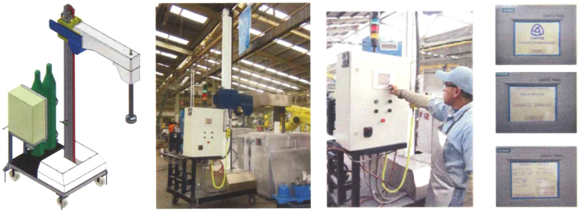
Figura 3.12 Desgasificador de impulsor rotatorio diseñado como parte del trabajo de investigación.
